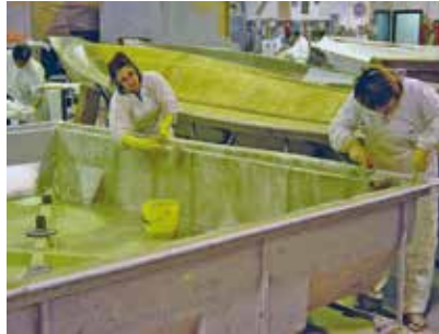
Lavorazione della vetroresina, inossidabile per natura
