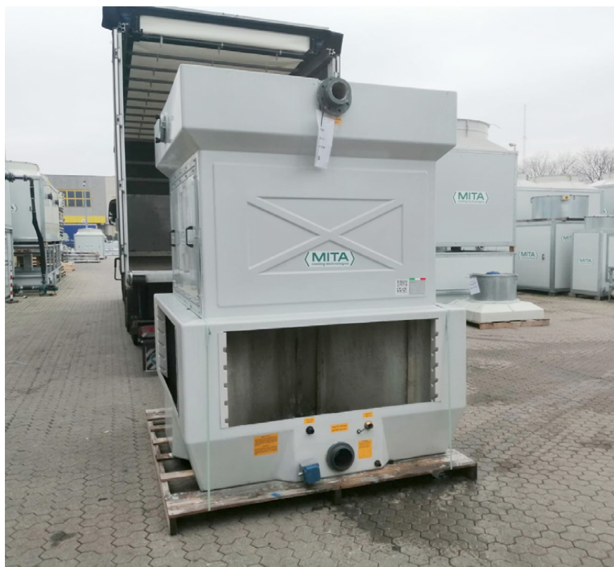
Una torre evaporativa MITA di 25 anni fa (Figura 1) rigenerata, ripulita e aggiornata tramite re-manufacturing (Figura 2)
