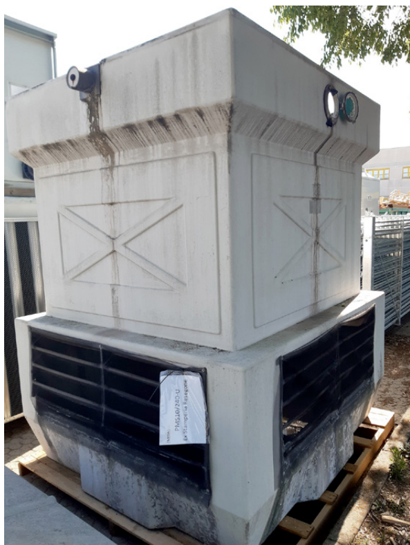
Una torre evaporativa MITA di 25 anni fa (Figura 1) rigenerata, ripulita e aggiornata tramite re-manufacturing (Figura 2)
